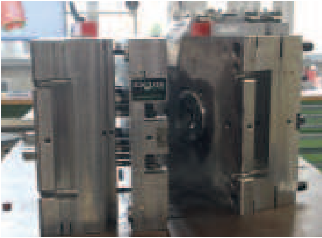
Die Experten fertigen Hochpräzisions-, Mehrkomponenten- und Multikavitätenwerkzeuge bis maximal 4 t, unter anderem für die Automobilbranche.
